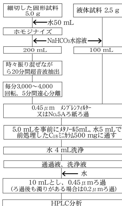
図1 試料溶液の調製法①
