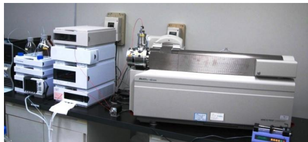
↑ 液体クロマトグラフタンデム型質量分析装置 抗生物質や抗菌剤を高感度に分析することが可能な装置
