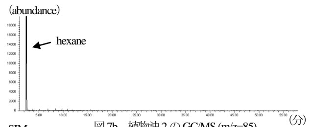
図 7b 植物油 2 の GCMS (m/z=85)
