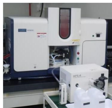
図 1 原子吸光光度計（奥）と水素化物発生装置（手前）
